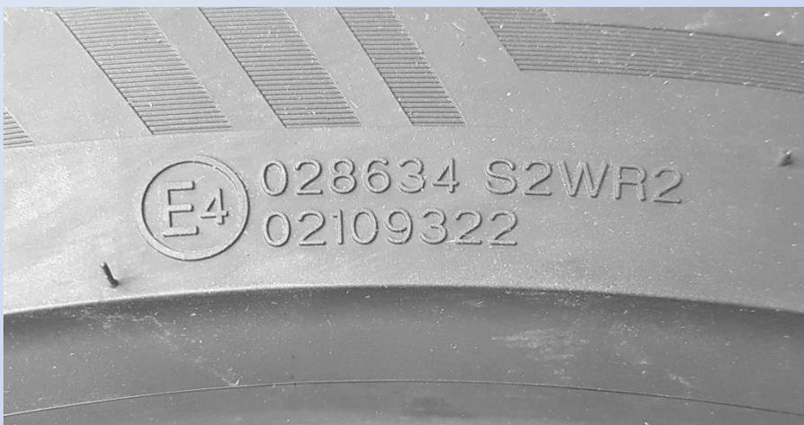
Limites pour le bruit (S), l'adhérence sur sol mouillé (W) et la résistance au roulement (R)
